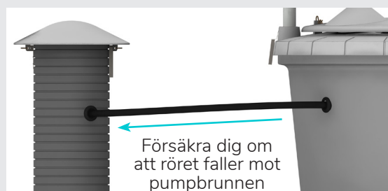
Bild 12: Påfyllnadsröret faller mot pumpbrunnen
